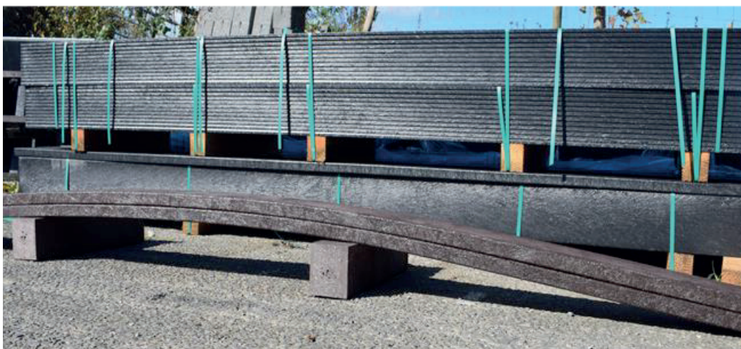
Opgeslagen profielen: Vooraan: foutief versus Achteraan: juist
