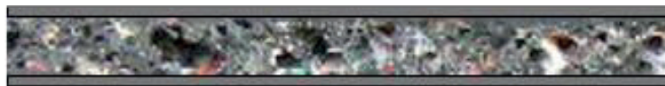
Doorsnede board 19 mm: kern van 15 mm tussen twee lagen skin van 2 mm
